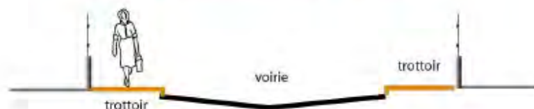
Profils en « V » des voies permettant un stockage provisoire des eaux
